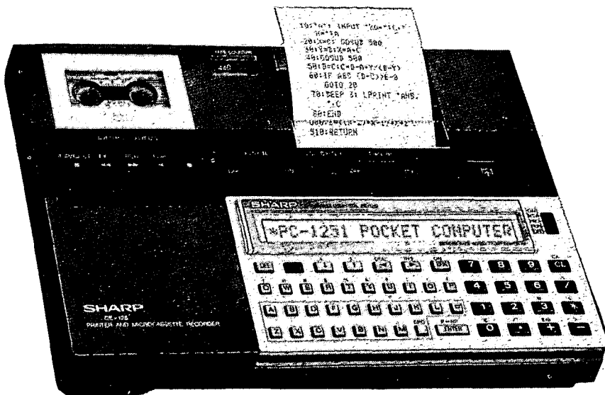
Kapesní mikropočítač PC-1251 zasunutý do základního modulu CE-125 s termickou tiskárnou a mikrokazetovým magnetofonem.
